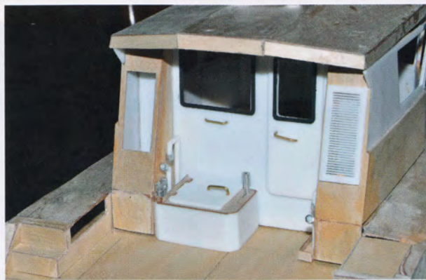
Mise en place des équipements de la face arrière de la timonerie.
